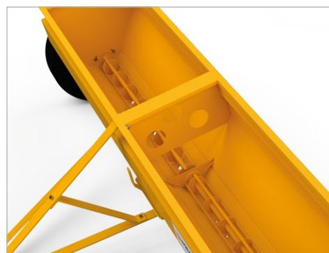
Sistema de distribuição com rotor agitador.
