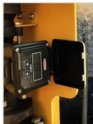
Fluxômetro: precisão na quantidade de calda incorporada
